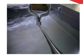
Druckluft-Trockenstation zum Abblasen der Bauteile nach dem Entgraten.
